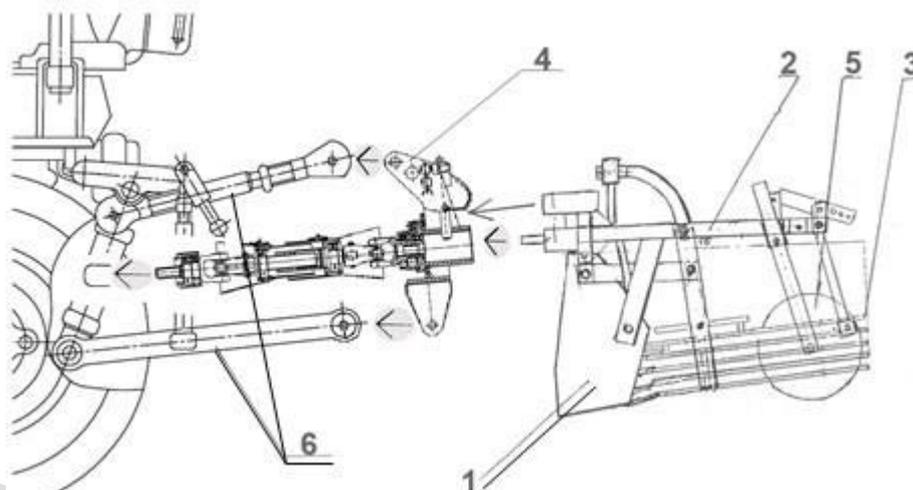
Рис.1. Общий вид картофелекопалки.
